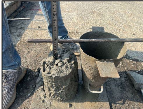
ការត្រួតពិនិត្យល្អមូលរបស់បេតុង (Slump test)
