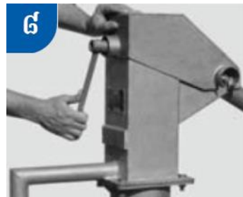
(៨) សង្កត់ដៃស្នប់ចុះក្រោម រួចដកកូនសោរទប់ពីក្បាលស្នប់ ហើយរឹតប៊ូឡុងទាំងអស់ឲ្យតឹងៗ គ្របគម្របស្នប់ ទៅលើក្បាលស្នប់ ហើយរឹតខ្មៅឲ្យតឹងៗ ធ្វើការសប់សាកល្បង និងពិនិត្យរកមើលការលិច និងការប្រើប្រាស់ទូទៅ
